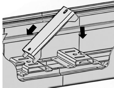
Rattacher le support de verrouillage avec 2 vis
