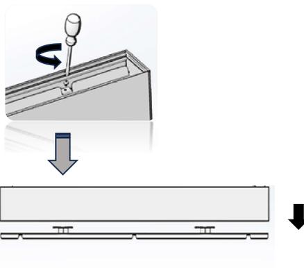
Desserrer les 2 vis et retirer l'embout
