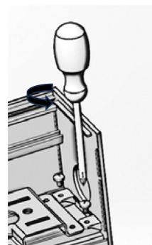
Insérer la plaque de raccord dans le boîtier
