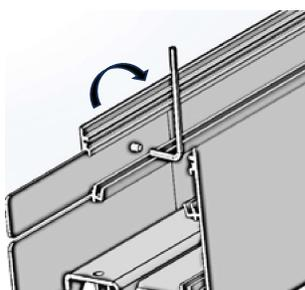
Insérer le support de raccord de verrouillage dans les supports
